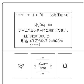
排水不良により、室内ユニットのドレンパンが満水になり発生するエラーです。原因として排水管先端部(屋外)に設置された、管末ドレントラップのふた、または弁の固着が想定されます。以下に従って処置をしてください。
