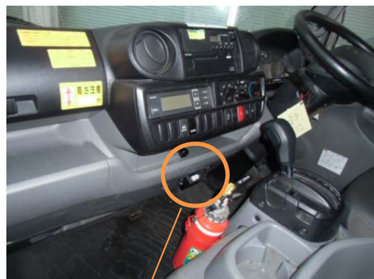
電池残量表示器 (キャビン内に設置)
